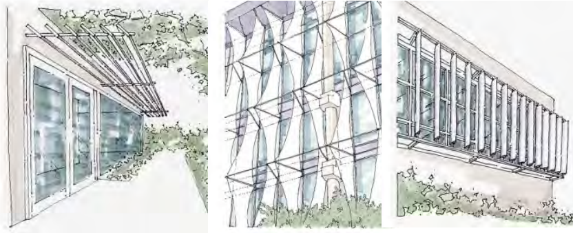
Gambar 3. Contoh Shading Device untuk Sisi Selatan (Kiri), Utara (Tengah), Barat dan Timur (Kanan) (Sumber: Dean, 2005)
