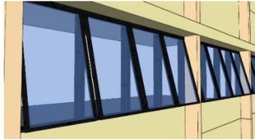
Gambar 4. Jendela dengan tipe bukaan *awning* pada eksisting bangunan
