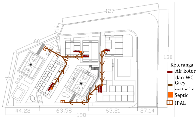
Gambar 8. Proses daur ulang air dan lokasi IPAL
