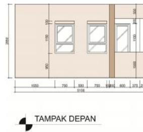
Gambar 7. Detail Bukaan pada Unit Hunian Tipe 2 BR 30 m<sup>2</sup>
