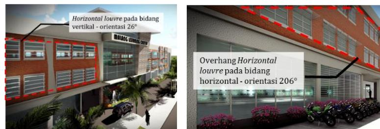
Gambar 5. *Shading device* yang digunakan pada rancangan.
