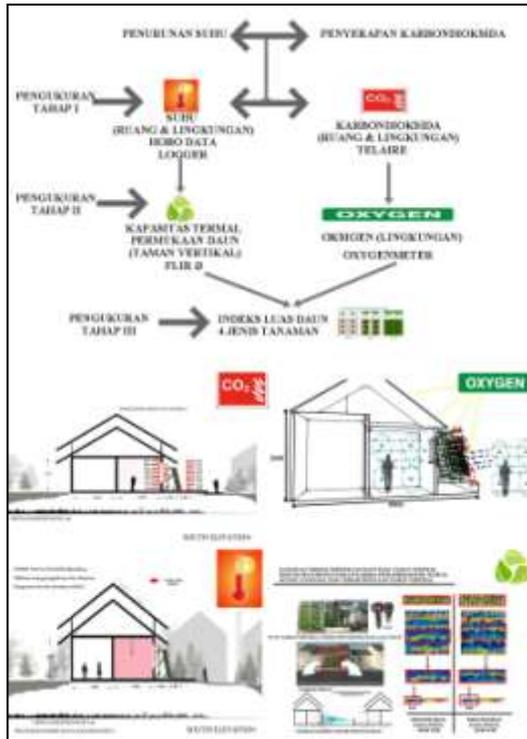
Gambar 2.4 Skema hubungan metode pengukuran
