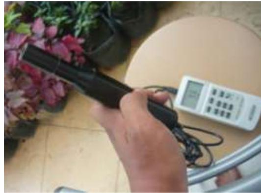
Gambar 3.7 Alat ukur oksigen (*oxygen meter*)
