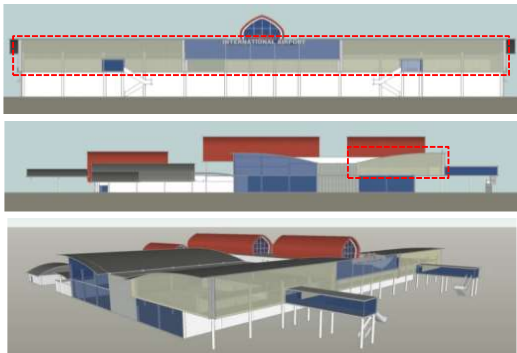
Gambar 4. Gambar tampak depan (atas), tampak samping (tengah), dan perspektif (bawah) metode kaca film
