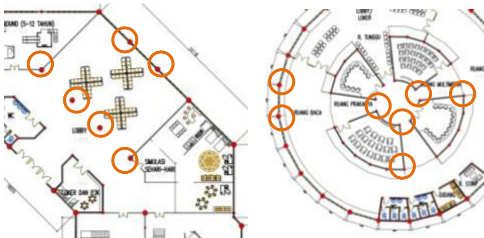
Gambar 7. Penggunaan kolom tabung dan sudut bangunan permainan indoor dan bangunan pendidikan menghindari bentukan runcing
