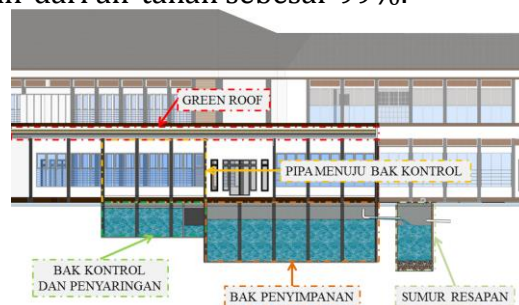
Gambar 7. Bak penampung air hujan
