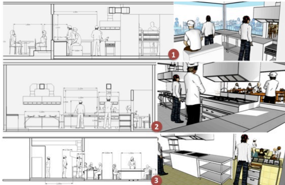
Gambar 6. (1). Potongan dan Detail Open Kitchen pada Dapur Jenis Masakan Bakso, (2). Potongan dan Detail Open Kitchen pada Dapur Jenis Masakan Cui Mie, (3). Potongan dan Detail Open Kitchen pada Dapur Jenis Masakan Rujak
