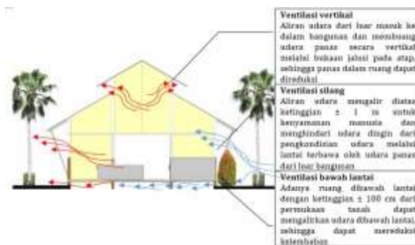
Gambar 4. Konsep Ventilasi pada Bangunan (Sumber: Hasil analisis, 2014)
