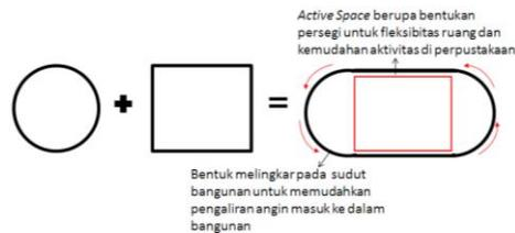
Gambar 12. Pemilihan Bentuk Dasar Bangunan Perpustakaan Bioklimatik
