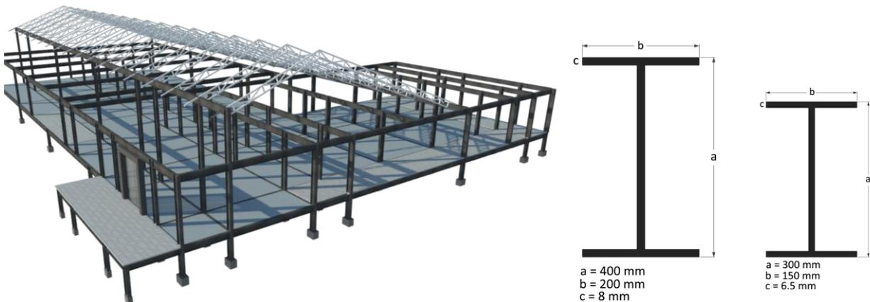
Gambar 7. Sintesis aplikasi baja WF sebagai material balok dan kolom
