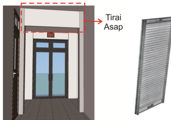
Gambar 9. Rekomendasi Tirai Asap pada Koridor dan Rolling Door
