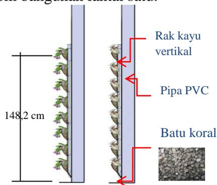
**Gambar 4.63** Detail rak pada kolom lantai satu
